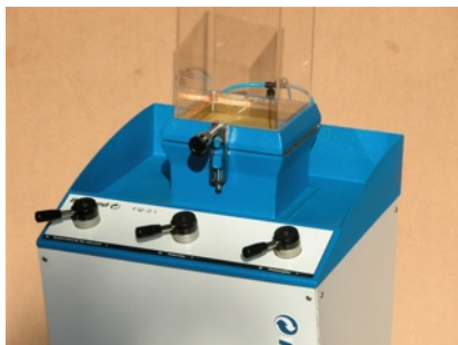
Controles pneumáticos individuais para enchimento, mistura e drenagem
