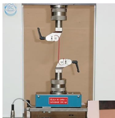
Tração de fios e cabos
