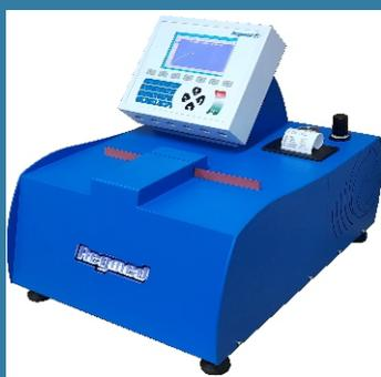
O SCT-21 determina em total conformidade com as Normas Técnicas a resistência à compressão de papéis miolo e capa, parâmetro determinante para o desenvolvimento e a fabricação de papelão ondulado bem como para seu posterior desempenho, notadamente no empilhamento.
