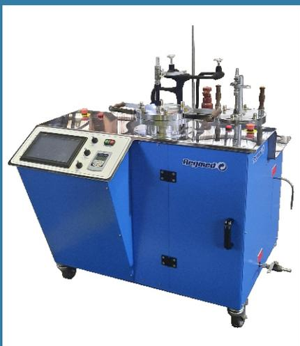
O Digestor de Laboratório modelo LabDigest, desenvolvido para trabalhos de polpação nas rotinas de P&D e C.Q., se aplica a todos os tipos de materiais celulósicos e biomassas. Ele possibilita leitura precisa de temperatura e pressão durante o cozimento, bem como controle automático de temperatura, inclusive rampa de aquecimento e patamar de cozimento (tempos e temperaturas), e ajuste da velocidade de circulação do licor.
