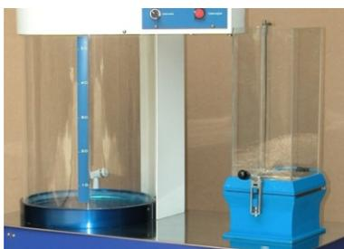
Reservatório de 50L e coluna formadora quadrada
