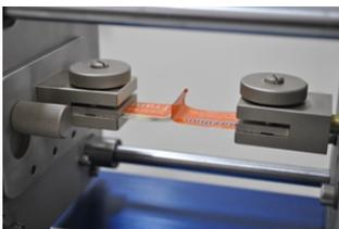
Ensaio de resistência da selagem à tração
