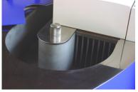
Reservatório e mesa de trabalho em aço inoxidável AISI 304; conjunto de facas e contra-facas de moagem em aço inoxidável AISI 420 temperados;
