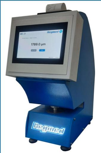
Equipamento utilizado para determinar a espessura exata de filmes plásticos.
